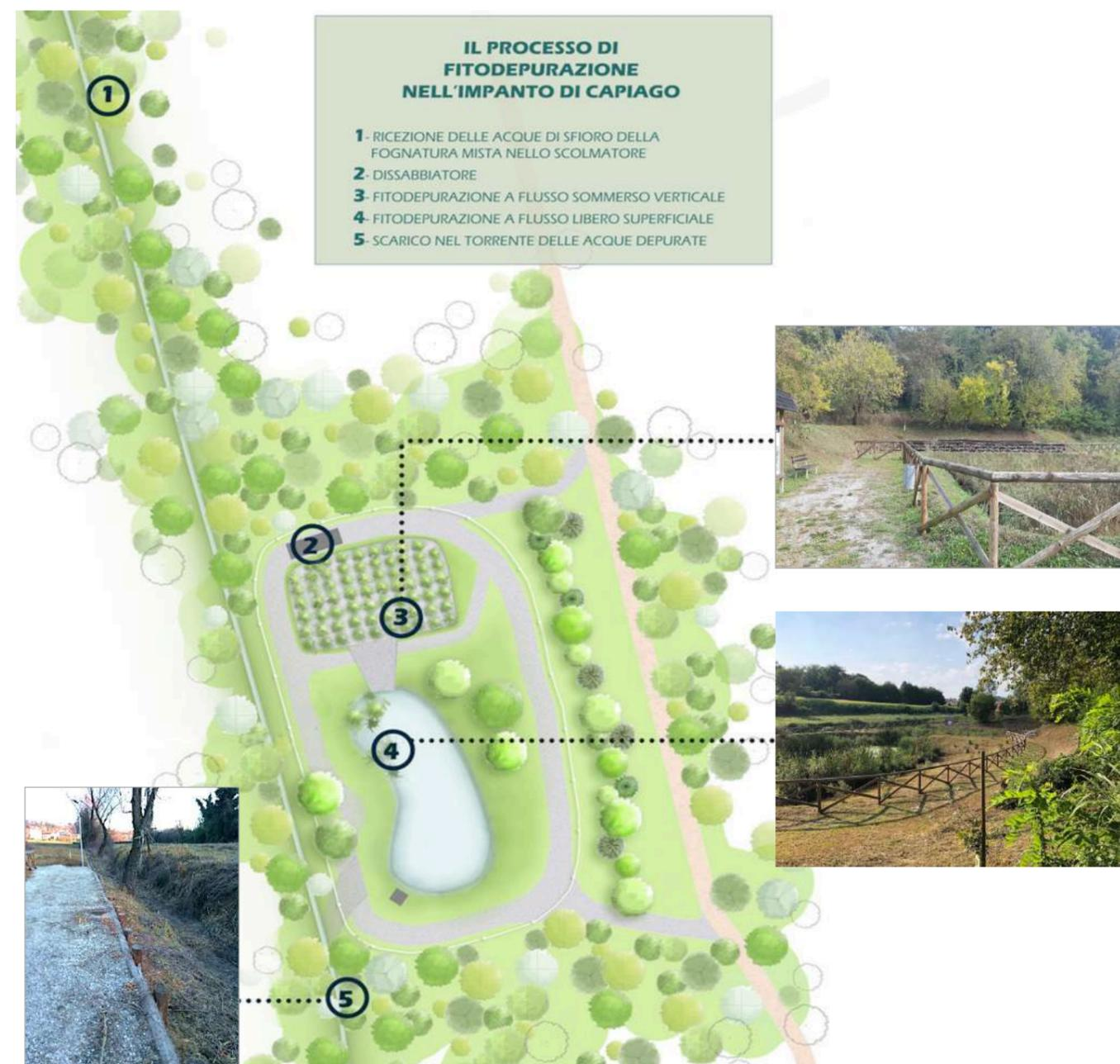
Il sistema è a fitodepurazione ibrida, in quanto la struttura del fitodepuratore è composta di due parti:
